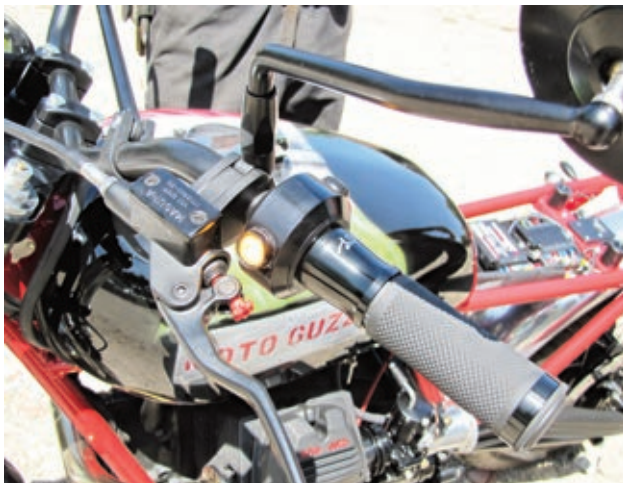
Die vorderen Blinker befinden sich in den selbst gefrästen Lenkerarmaturen.
