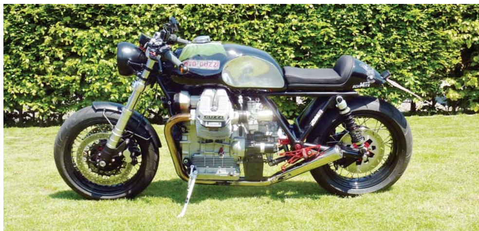
Auf diesem Bild ist noch ein anderer Auspufftopf montiert, damit gab es aber ein Leistungsloch bei 5.000 U/min.
